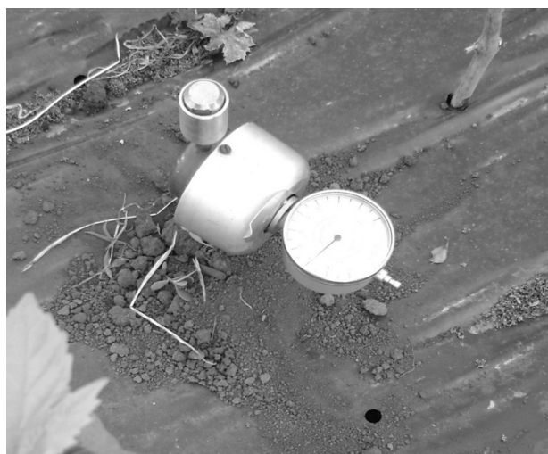
Рисунок 2 – Тензиометр со съемным индикатором
