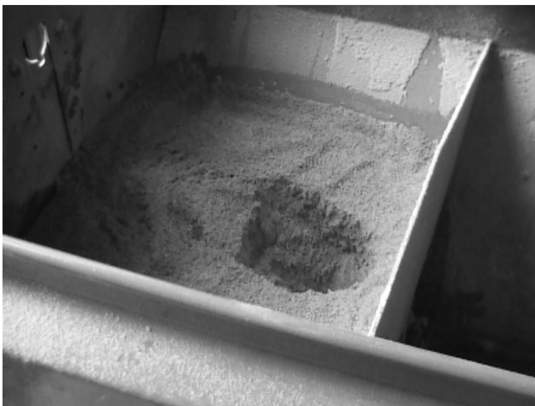
Рисунок 4 – Момент появления провала в семенном материале над дальней частью спирали
