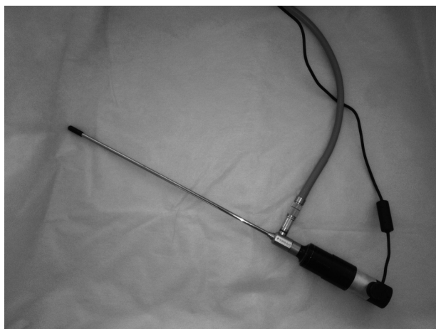
Рисунок 1 – Оптическая система лапароскопа с присоединенным световодным кабелем и веб-камерой
