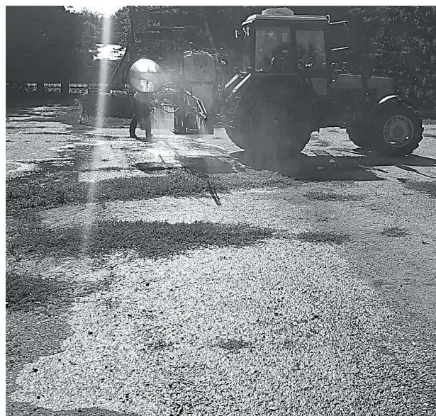
Рисунок 3 – Процесс осаждения капельной жидкости за пределы края штанги навесного опрыскивателя при распространении воздушно-капельной системы, создаваемой щелевыми распылителями и воздушным потоком от вентилятора с коническим соплом
