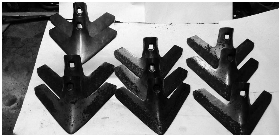
Рисунок 3 – Стрельчатые лапы после полевых работ
