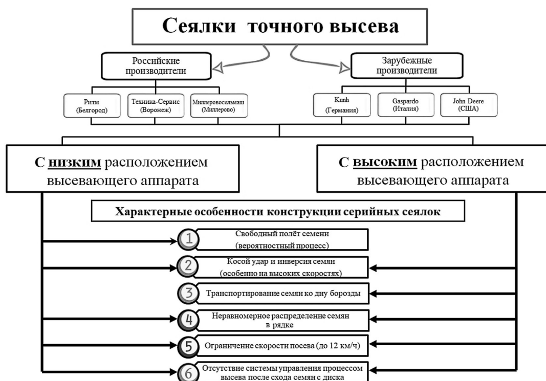
Рисунок 7 – Классификация сеялок точного высева согласно расположению их высеваших аппаратов и ключевые особенности серийно выпускаемых сеялок
