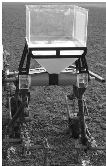
Рисунок 2 – Туковысевающий аппарат АТГ-2 установленный на культиваторе КРН – 5,6 А.
