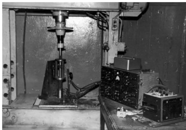
Рисунок 1 – Установка для исследования процесса прессования рассыпных материалов в закрытом контуре
