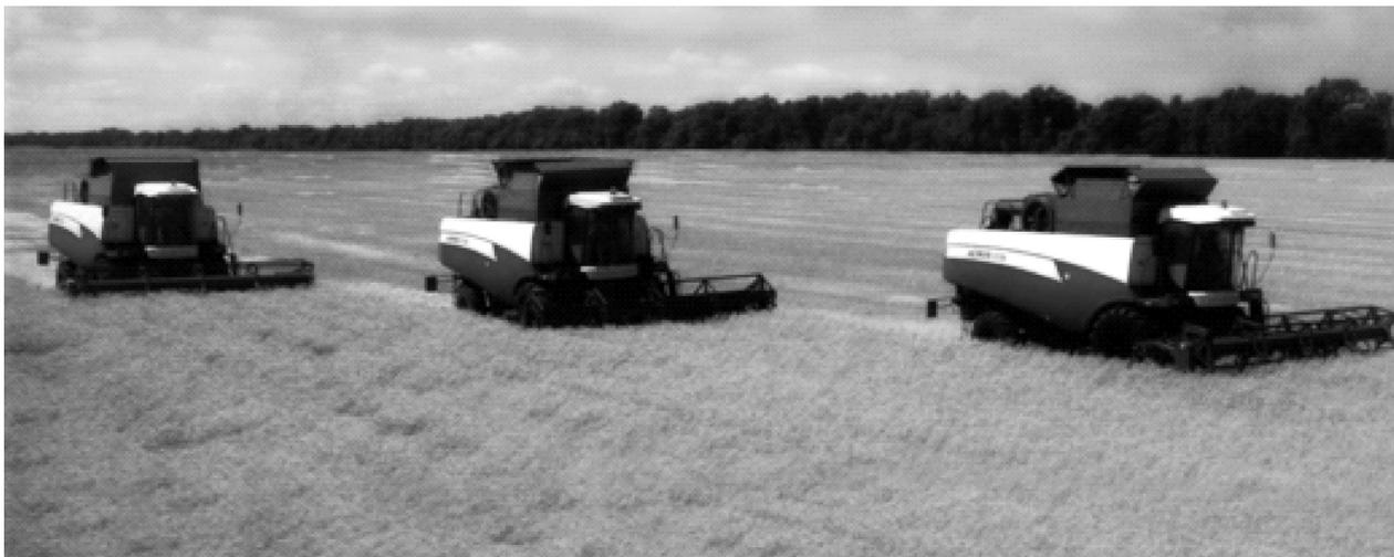
Рисунок 2 – Звено комбайнов «Acros 530» с жатками Power Stream на прямом комбайнировании хлебов
