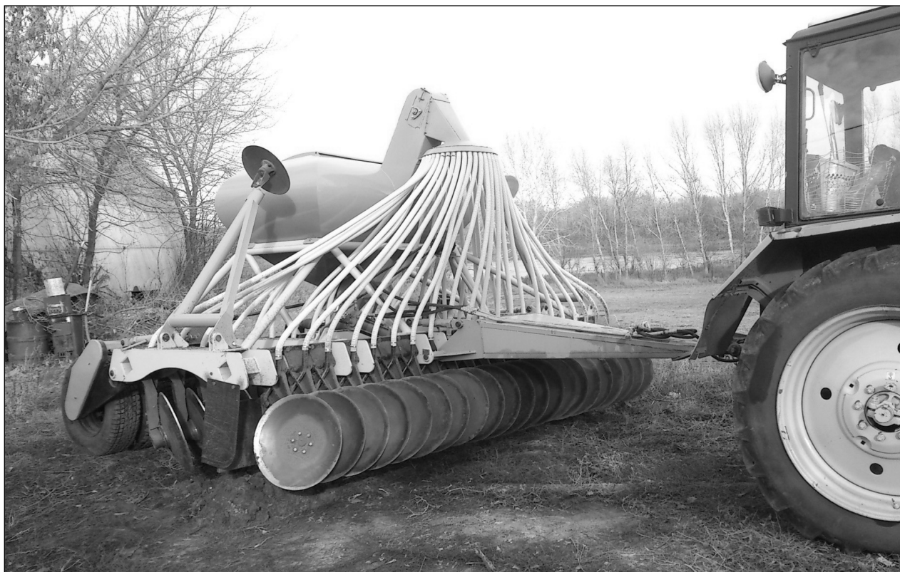
Рисунок 4 – Изображение опытного образца посевного комплекса
