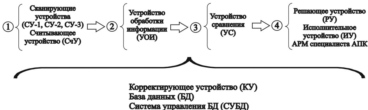
Рисунок 5 – Алгоритм работы устройства биометрической аутентификации животного по биометрическому паспорту
