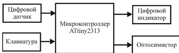
Рисунок 3 – Структура модуля стенда микроконтроллерного
