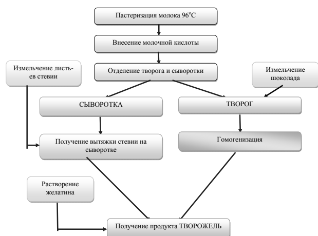
Рисунок 3 – Блок-схема технологического процесса производства десерта «Творожель»
