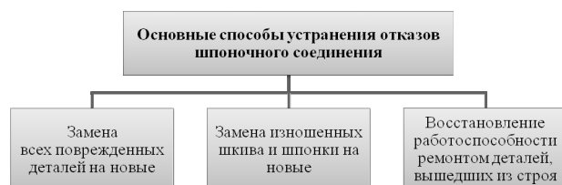
Рисунок 1 – Основные способы устранения отказов шпоночного соединения
