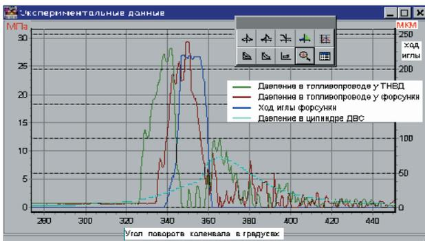
Рисунок 1 – Пример представления экспериментальных данных в графическом виде на экране дисплея при помощи программы «Engine Capture»
