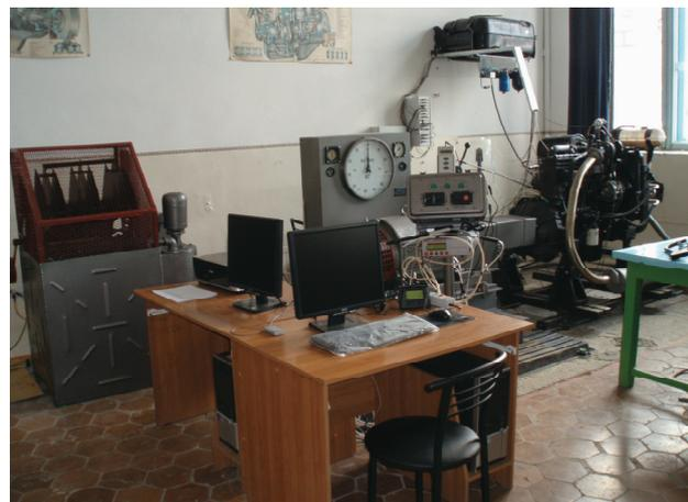
Рисунок 2 – Испытательная энергетическая установка с двигателем Д-245.12С с информационно-вычислительным комплексом «ИВК ДВС»
