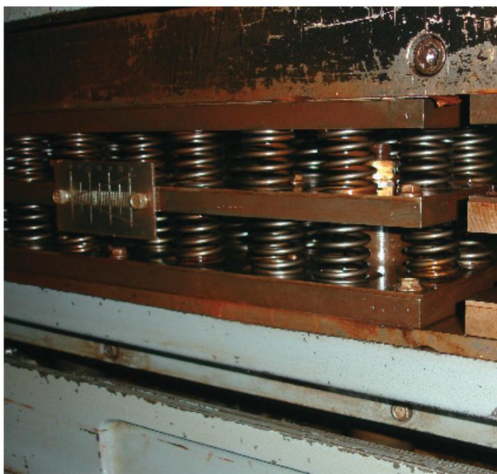
Рисунок 2 – Стенд резонансного типа DV8-S2 фирмы «Gejrg Reicherter», Германия
