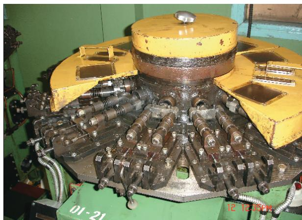
Рисунок 1 – Стенд СБН 0121 № 004 для испытания пружин
