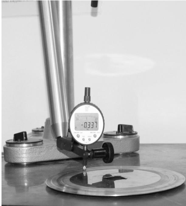
Рисунок 2 – Схема измерения износа диска
