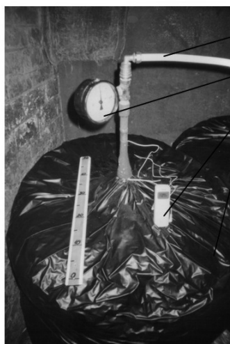
Рисунок 1 – Схема и общий вид установки для исследования барометрического, влажностного и температурного режимов хранения растительных кормов в гибких упаковках с поддержанием пониженного давления в заданных пределах (варианты 1 и 2) и без такового (вариант 3 контроль)
